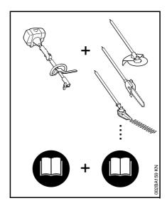
Con el sistema Kombi de STIHL, varios motores Kombi y accesorios Kombi pueden combinarse para formar una herramienta motorizada. En este manual de instrucciones la unidad formada por el motor Kombi y el accesorio Kombi se identifica como la herramienta motorizada.
