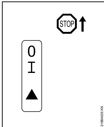
**Stop 0** – motor apagado – el encendido está apagado
