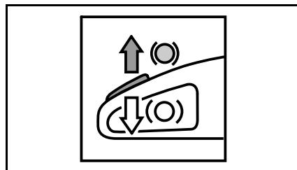
El mecanismo de activación del sistema de freno de la cadena STIHL Quickstop Plus forma parte integral del bloqueo del gatillo de aceleración (mango trasero). Una de las grandes ventajas de este sistema es que la cadena de aserrado está bloqueada automáticamente cuando se transporta la motosierra, con el motor en marcha, agarrada del mango delantero (con el mango trasero completamente suelto).
