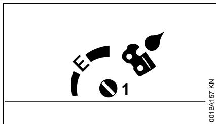
Use el tornillo de ajuste (1) (en la parte inferior de la máquina) para variar el ritmo de alimentación de aceite según sea necesario.
