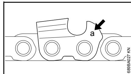
La marca (a) de paso de la cadena está trabada en la zona del calibrador de profundidad de cada cortador.
