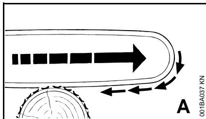
El tirón se produce cuando la cadena de aserrado en la parte inferior de la espada se detiene repentinamente por estar aprisionada, quedar atrapada o entrar en contacto con algún objeto extraño en la madera. Como reacción, la cadena de aserrado tira de la motosierra hacia adelante y el operador corre el riesgo de perder el control de la máquina.
