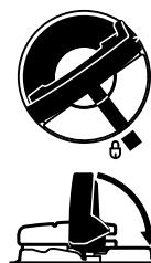
Doble la empuñadura dejándola a ras con la parte superior de la tapa. Sujete la tapa y compruebe que esté bien apretada. Si la empuñadura no queda completamente a ras con la tapa y el tope de la empuñadura no encaja en la hendidura correspondiente de la abertura de llenado, o si la tapa está suelta en la boca de llenado, la tapa no está debidamente asentada ni apretada y es necesario repetir los pasos previamente descritos.
