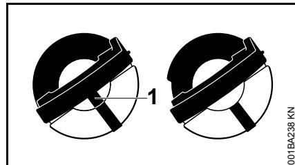
A izquierda: Parte inferior de tapa en posición cerrada – la marca interior (1) está alineada con la exterior.
