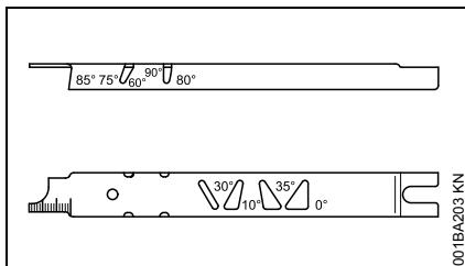
El calibrador de afilado STIHL (accesorio especial, consulte la tabla "Herramientas de afilado") – una herramienta universal para revisar el afilado y ángulo de las placas laterales,
