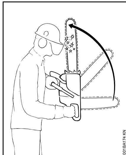
En una máquina debidamente mantenida, hay dos mecanismos que activan el freno de la cadena:
