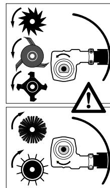
En las herramientas de metal (ilustración superior), coloque la caja de engranajes de modo que el eje esté debajo del tubo de mando.
