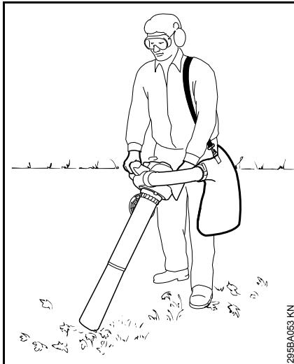
El accesorio de aspiradora está diseñado para usarse con las dos manos. Sostenga y maneje la máquina colocando la mano derecha en el mango de control y la izquierda, en el mango auxiliar.
