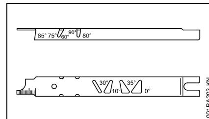
Utilice un calibrador de rectificación STIHL (accesorio especial – vea la tabla "Herramientas de afilado"). Esta es una herramienta universal para revisar los ángulos de rectificación y de la placa lateral, el ajuste de los calibradores de profundidad, el largo de los cortadores y la profundidad de la ranura. Además, limpia la ranura de la espada y los agujeros de entrada de aceite.
