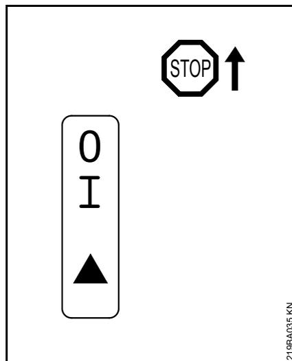
**Stop 0** – motor apagado – el encendido está desconectado
