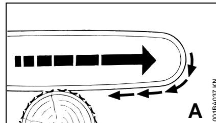
El tirón ocurre cuando la cadena en la parte inferior de la espada se detiene repentinamente cuando queda aprisionada, retenida o choca con algún objeto extraño en la madera. Como reacción, la cadena tira de la sierra hacia adelante haciendo que el operador pierda el control de la máquina.
