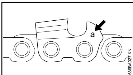
El paso de la cadena (a) está marcado en el extremo de calibrador de profundidad de cada cortador.
