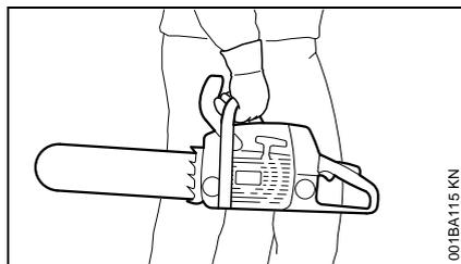
Puede acarrearla solamente en posición horizontal. Agarre el mango delantero de una manera que mantenga la máquina equilibrada horizontalmente. Mantenga el silenciador caliente lejos de su cuerpo y el accesorio de corte detrás de usted.
