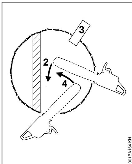
Evite reposicionar la sierra más de lo necesario. Cuando cambie de posición para el próximo corte, mantenga la espada totalmente dentro de la entalla para mantener un corte de tala recto. Si la sierra empieza a quedar aprisionada, inserte una cuña para abrir el corte. En el último corte, no corte el eje de inclinación del árbol.
