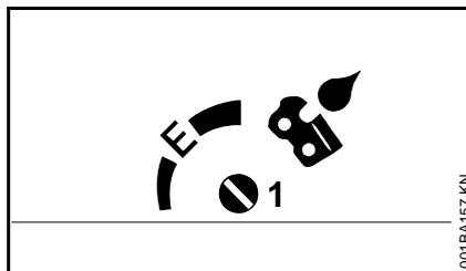
La entrega de aceite puede ajustarse según sea necesario usando el tornillo de ajuste (1) (en el fondo de la máquina).
