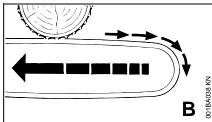
El rechazo ocurre cuando la cadena en la parte superior de la espada se detiene repentinamente cuando queda aprisionada, retenida o choca con algún objeto extraño en la madera. Como reacción, la cadena impulsa repentinamente la sierra hacia atrás contra el operador y puede causar la pérdida del control de la sierra. El
